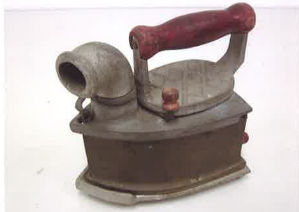
炭火アイロン 形は現在のアイロンとほぼ同じですが、中に炭を入れて使いました。炭の火が消えないように後ろには空気の取り入れ口があり、煙突もあります。
