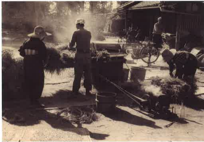
動力式脱穀機を使っでの脱穀作業。刈り取った稲穂から穀粒(籾)を取ることを脱穀と言います。発動機の回転をベルトで脱穀機に伝えて、脱穀作業を行います。
