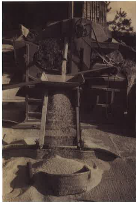
動力式脱穀機を使っでの脱穀作業。刈り取った稲穂から穀粒(籾)を取ることを脱穀と言います。発動機の回転をベルトで脱穀機に伝えて、脱穀作業を行います。
