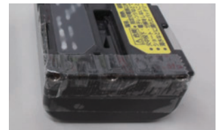
小型充電式電池(バッテリー)を絶縁処理した例
